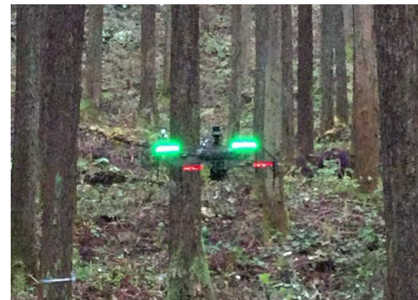
図11:電動ドローンによる林内飛行
