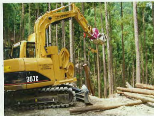
◎スイングヤーダ 油圧のショベルカーにウインチを搭載した機械。旋回可能なアームがタワーの代わりとなっており、ワイヤで木を集める。
