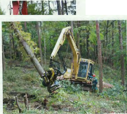
◎ハーベスタ 立木を伐倒し、枝を払って、丸太に切りつめ、集積することが1つの作業機で行える機械。
