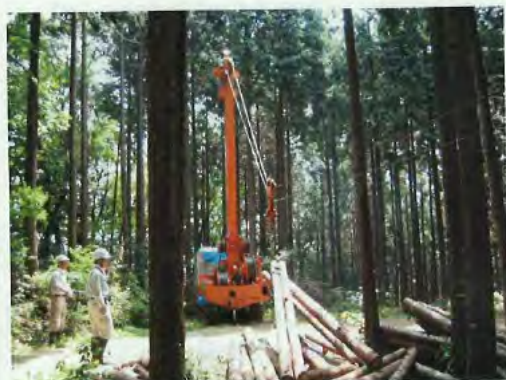
◎タワーヤーダ 切り倒した木を作業場所まで集めるための機械。6~10m程度のタワーの先からワイヤーロープを張って木を集める。移動が容易にできるのが特徴。
